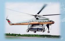
В 1964 году ростовский завод начал выпуск нового «тяжеловеса» — Ми-10. Основным отличием от Ми-6 стал способ размещения груза: этот вертолет был оснащен высоким шасси, между стойками которого размещена грузовая платформа. Таким образом он мог перевезти груз больших размеров и весом до 15 т. Это могли быть различные контейнерымодули, например, грузовой, пассажирский, санитарный.
